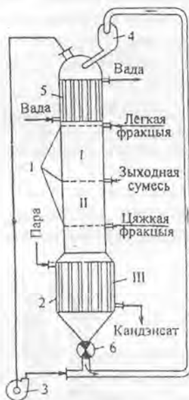
Рыс. 7.5. Адсорбер з рухальным пластом адсарбенту: I – зона адсорбцыі; II – зона рэктыфікацыі; III – зона дэсорбцыі; 1 – размеркавальная рашотка; 2 – цеплаабменнік-дэсорбер; 3 – газавыдзімалка; 4 – бункер; 5 – халадзільнік; 6 – разгрузачнае прыстааванне
