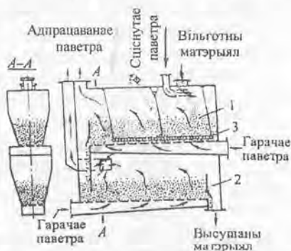
Рыс. 10.21. Двухкамерная сушылка з «квіпачым» пластом:
