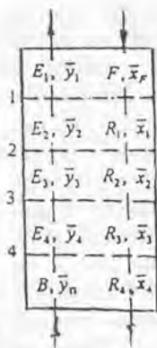
Рыс. 6.12. Схема шматступеневай супрацьцёчнай безупынной экстракцыі
