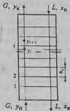
Рис. 3.11. Схема для разліку эфектыўнасці талеркі
