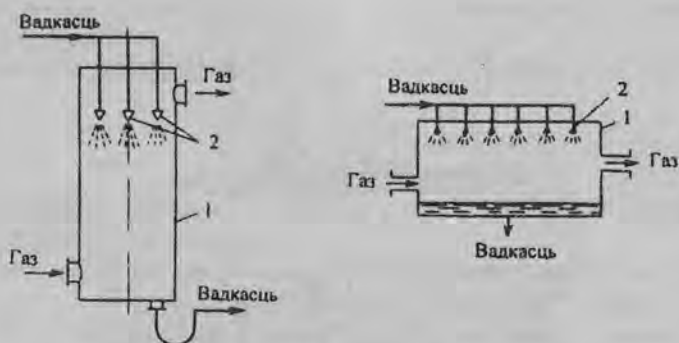
Рис. 4.27. Полю распыляльны абсорбер: 1 – корпус; 2 – фарсункі
