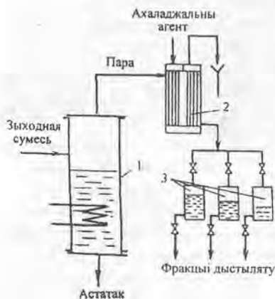
Рыс. 5.7. Схема паступовага выпарэння: 1 - выпарнік; 2 - кандэнсатар; 3 - зборнікі
