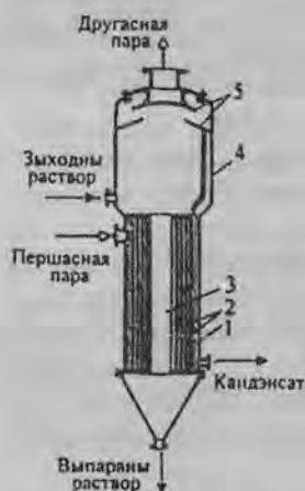
Рис. 2.9. Випарний апарат з центральною циркуляційною трубою: 1 – корпус; 2 – нагрівальна камера; 3 – циркуляційна труба; 4 – сепараторна пристора; 5 – кріплеулоуник
