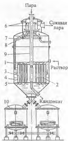
Рыс. 8.11. Выпарны апарат з падвешанай нагрэвальнай камерай;
