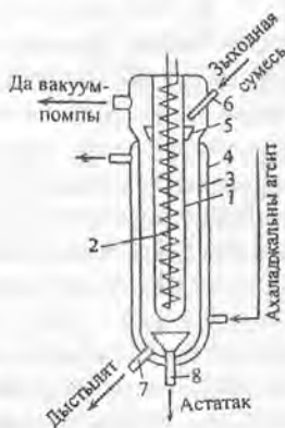
Рыс. 5.24. Найпрасцейшы апарат для малекулярнай дыстыляцыі: 1, 3 – цыліндр; 2 – электранагрэвальнік; 4 – кажух; 5 – лейка; 6, 7, 8 – патрубкі
