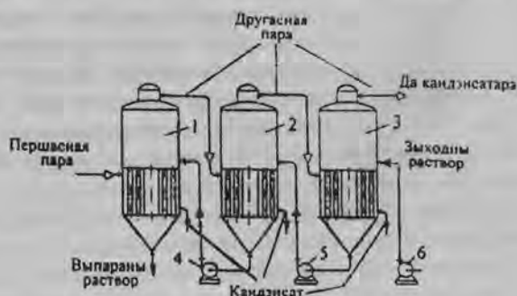
Рис. 2.4. Шматкорпусная выпарная ўстаноўка з супрацьдэчным рухам пары і раствору:
